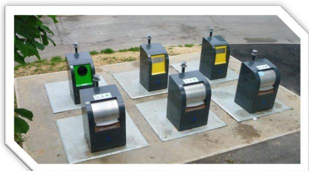
Sur certains sites en habitat vertical, en remplacement des bacs roulants, le système de colonnes enterrées ou semi enterrées est proposé.
